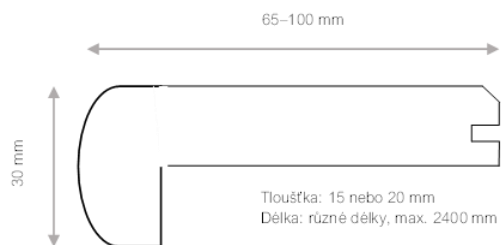
Obr. č. 3 – masivní schodová hrana
